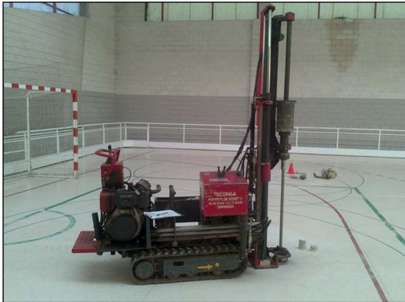
**Vista del equipo de penetración dinámica en el punto P-7.**
