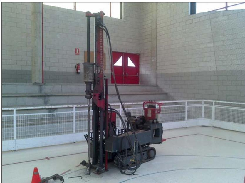
**Vista del equipo de penetración dinámica en el punto P-8.**
