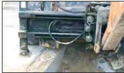
Apoyo sobre dos superficies de diferentes resistencias.
