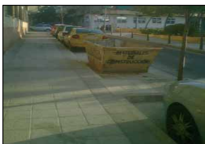
Contenedor colocado sin sobresalir de la línea exterior formada por los vehículos correctamente estacionados
