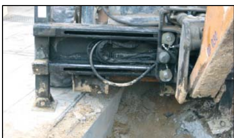
Apoyo sobre dos superficies de diferentes resistencias.
