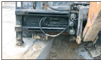
Apoyo sobre dos superficies de diferentes resistencias.
