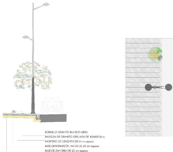
Figura 17. Detalle Pavimentación General acera mediante baldosa de granito Gris Alba
