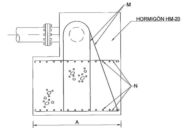
NOTA.- TODOS LOS M.A. LLEVARÁN UNA CAMA DE HORMIGÓN DE LIMPIEZA DE 10 cm. DE ESPESOR
