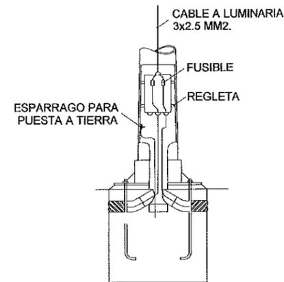
SISTEMA DE FIJACIÓN DE SOPORTE. DETALLE ENTRADA ENTUBADO
