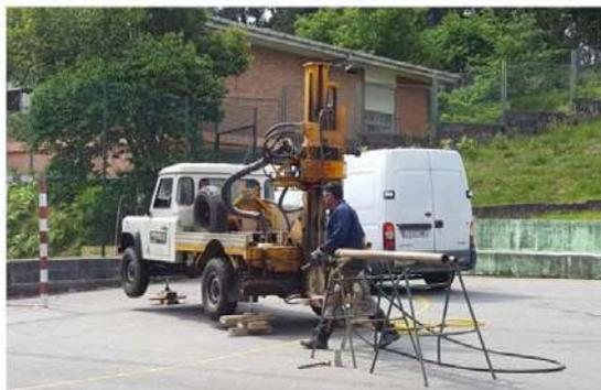
Durante la ejecución de los sondeos, se han realizado varios ensayos de resistencia y toma de muestras: 4 SPT “Standart penetration Test”, según UNE 103800, los cuales consisten básicamente en golpear sobre la cabeza de un varillaje al que está unido sólidamente el tomamuestras, mediante una maza con una masa de 63.5 Kg. y con una altura de caída de 760 mm.
