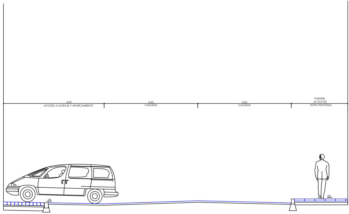
Sección C-C. (Sección tipo en acceso a garajes)
