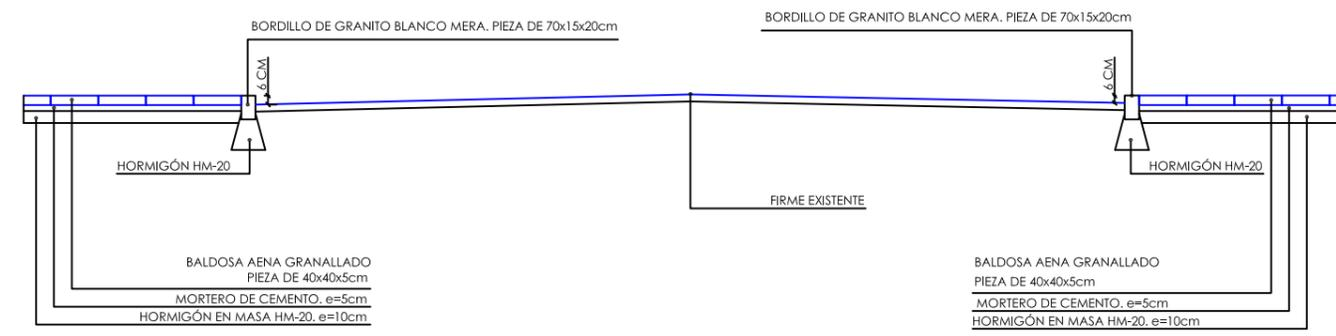
Sección A-A. Detalle de sección de firme
