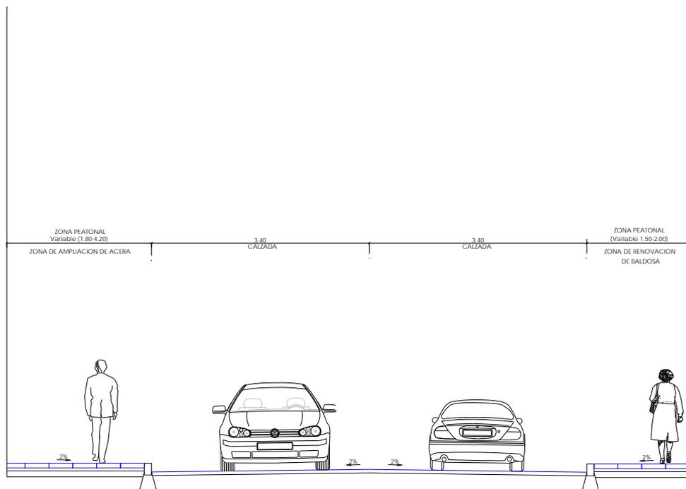
Sección tipo ampliación y renovación aceras ambos márgenes (sin zona de aparcamiento)
