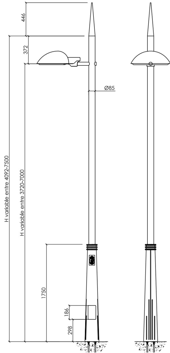
TIPO DE FUNDICION: Fundición nodular en grafito esferoidal EN-GJS-500-7.
