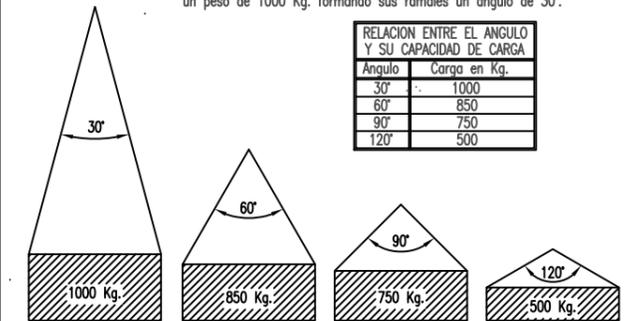
La carga maxima que puede soportar una eslinga depende, fundamentalmente, del angulo formado por los ramales de la misma. A mayor angulo, menor será la capacidad de carga de la eslinga.
