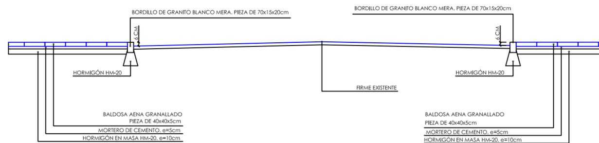
Sección B-B. Detalle de sección de firme
