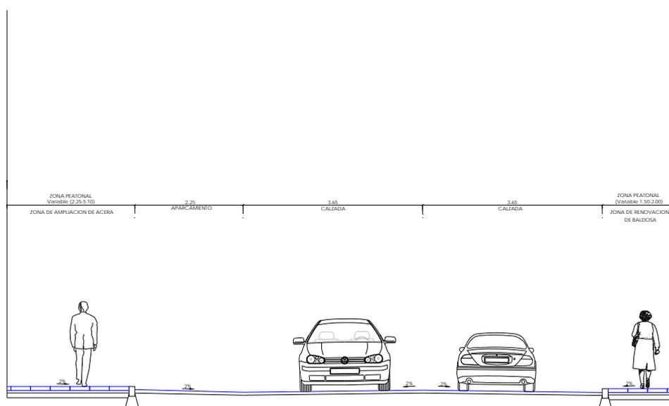
Sección tipo ampliación y renovación aceras ambos márgenes (con zona de aparcamiento)
