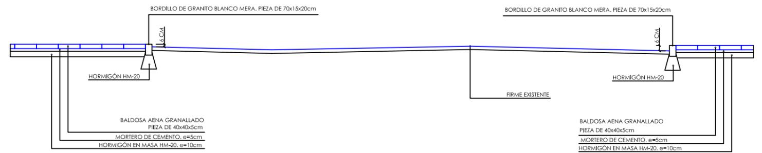
Sección B-B. Detalle de sección de firme
